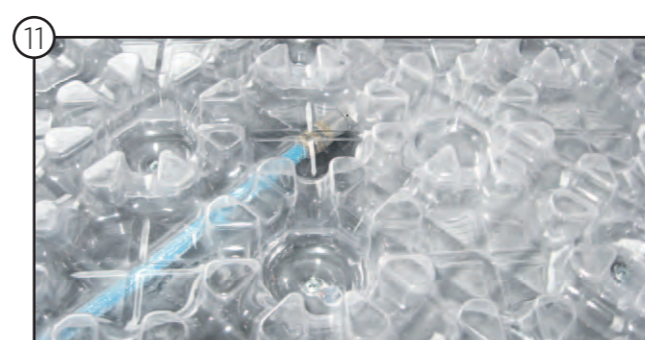
Pressluftdüse während der Reinigung
