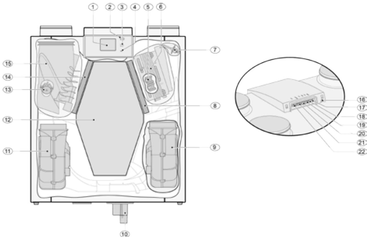
Das oben gezeigte Gerät ist eine Linksausführung; bei einer Rechtausführung sind Vorheizregister, Bypassklappe und Siphonanschluss gespiegelt montiert!
