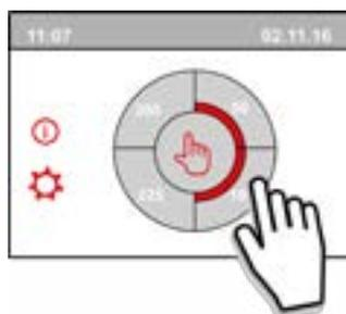
Der Touchscreen kann auch permanent als Stufenschalter eingestellt werden; dazu muss im Einstellmenü unter Schrittnummer 15.8 die Einstellung „Ja“ gewählt werden.
