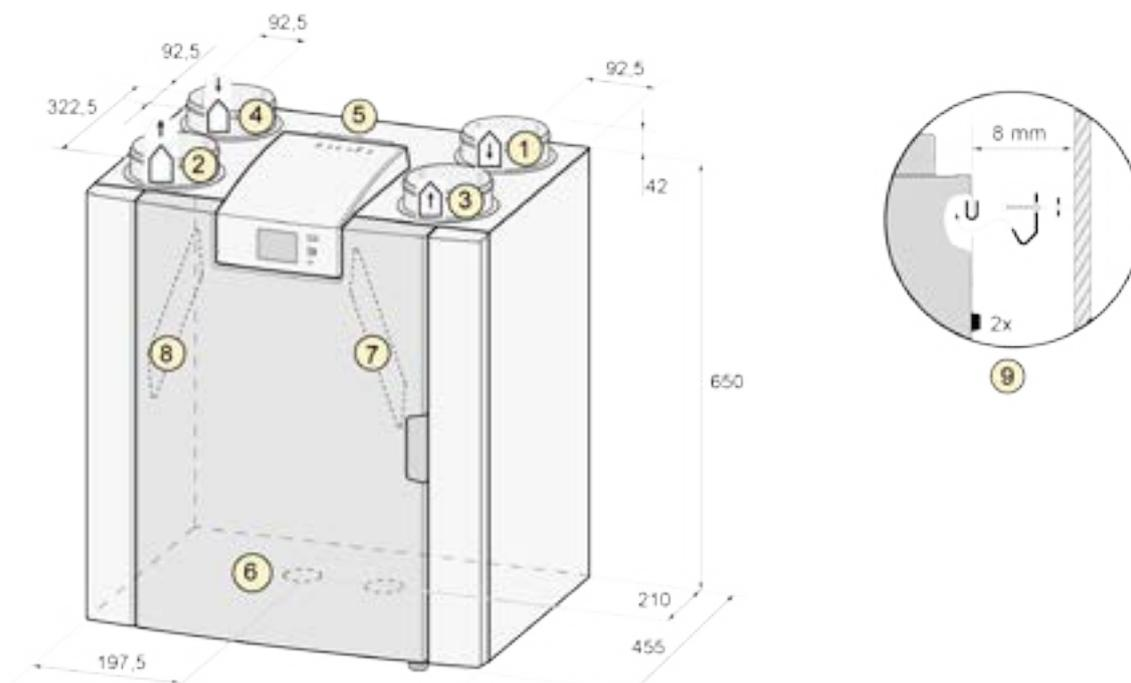
Alle Abmessungen sind in mm angegeben. Der Durchmesser sämtlicher Bundringe beträgt 125 mm.
