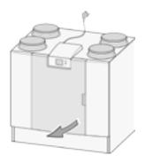
2 Entfernen Sie die beiden Filter.
